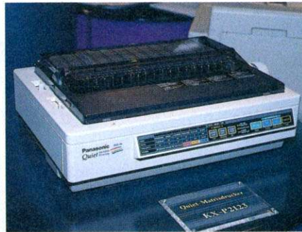
Leiser Nadler Beim Panasonic KX-P2123 drucken nur zwei Nadeln auf einmal aber das rasend schnell
