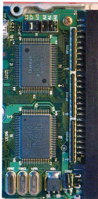
Prodrive LPS Die Jumper liegen oben und die Terminierwiderstände rechts
